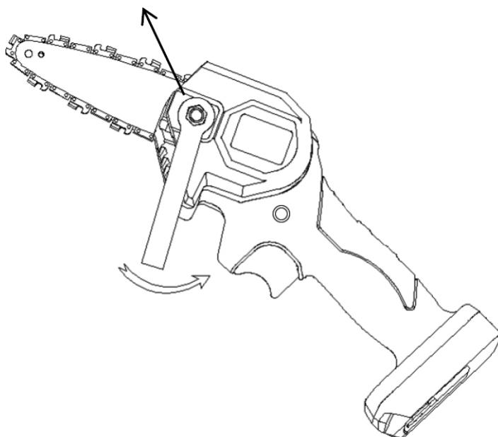
Drehen Sie die Einstellschraube wie abgebildet im Uhrzeigersinn, um die Kette zu spannen, und gegen den Uhrzeigersinn, um sie zu lockern.
