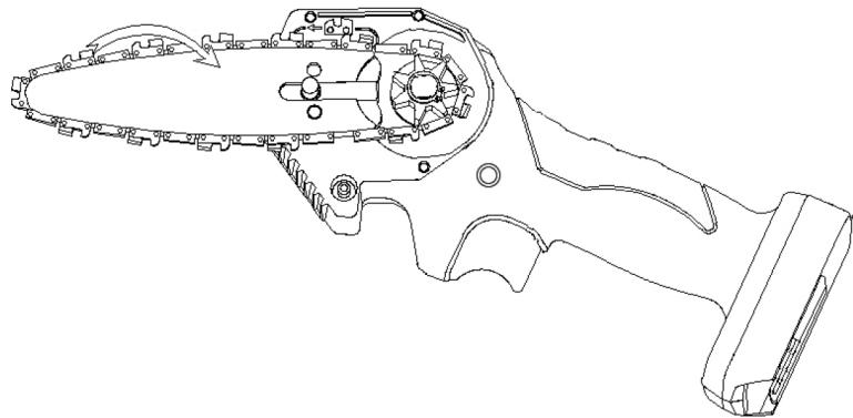
**2.2 Wie kann ich die Kette entfernen?** Nach dem Abnehmen der Seitenabdeckung lösen Sie die Druckschraube, entfernen die Führungsschiene und nehmen die Kette ab.
